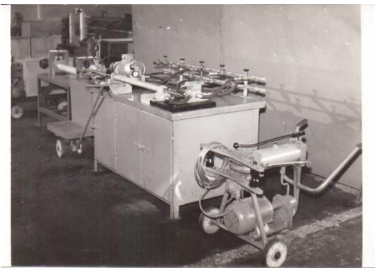
Dispozitivul de șebăruit, acționat hidraulic!
